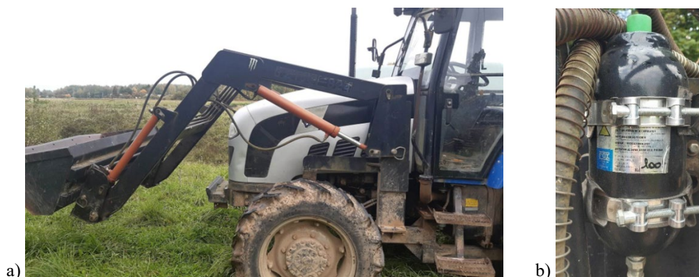
1 pav. a – „Foton 904“ traktorius su krautuvu b – ir hidrauliniu akumulatoriumi
