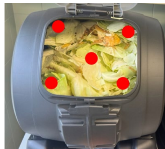
2 pav. Temperatūros, pH, druskingumo matavimo taškai Fig. 2. Measuring points for temperature, pH, salinity
