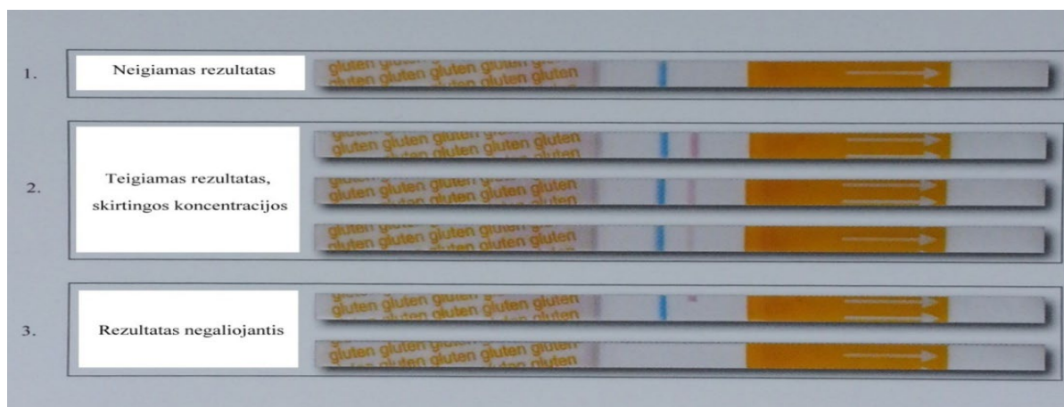
1 pav. Tyrimo rezultatų vertinimas taikant RIDA®QUICK Gliadin testą
