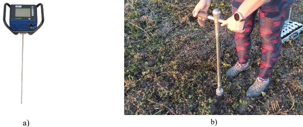
2 pav. Dirvožemio tyrimams atlikti naudota įranga: a) kietmatis Eijkelkamp; b) dirvožemio mėginių ėmimo grąžtas
