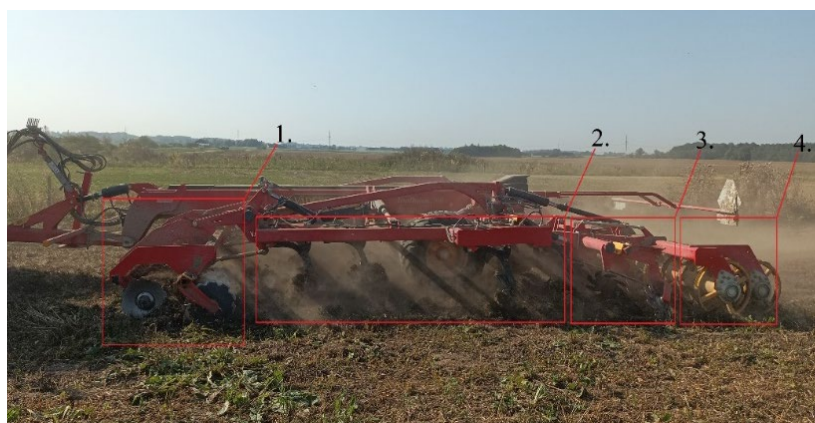
2 pav. Kintamo gylio žemės dirbimo daugiafunkcis skutiklis „Väderstad TopDown 500“: 1 – dirbimo diskai, 2 – noragai, 3 – lyginimo diskai, 4 – U formos dvigubi tankinimo volai
