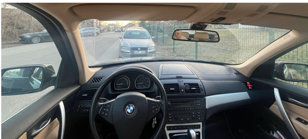
5 pav. Vairuotojo vietos matymo lauko vaizdas esant reglamentuotai (0) vairuotojo sėdėsenos pozicijai
