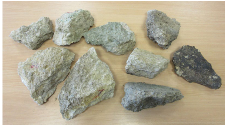
1 pav. Netaisyklingos formos betono gabalai bandiniams
