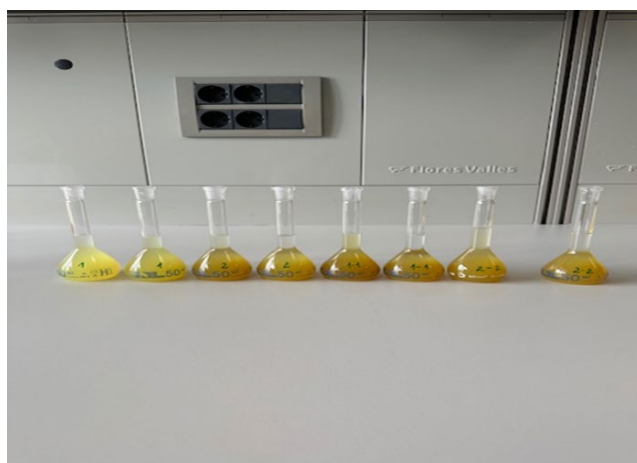
1 pav. Svogūnų sulčių (vidinės ir išorinės dalies) paruošti ėminiai elektrocheminiams rodikliams nustatyti Fig. 1. Prepared samples of onion juice (inner and outer part) for determination of electrochemical indicators
