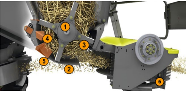
1 pav. Šiaudų smulkintuvus su radialiniu šiaudų skleistuvu: 1 – smulkintuvo rotorius; 2 – smulkintuvo dugnas; 3 – smulkinimo peilis; 4 – smulkinimo priešpeilis; 5 – smulkinimo agresyvumo pakrepiama plokštė; 6 – radialinis skleistuvus
