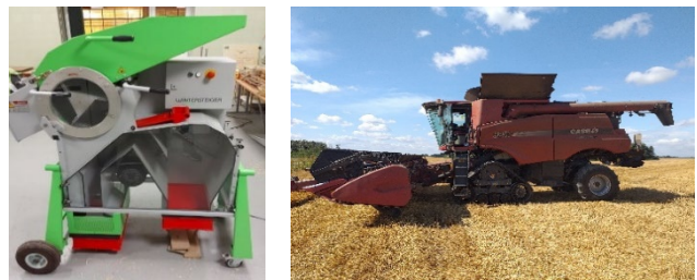
1 pav. Kūlimo įrenginiai: a – laboratorinis kūlimo įrenginys „Wintersteiger LD 350“; b – savaeigis javų kombainas „Case IH 9230 Axial Flow“
