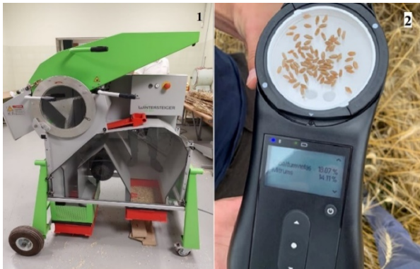
1 pav. Javų derliaus kūlimo mašina ir grūdų kokybės nustatymo įranga: 1 – laboratorinis kombainas „Wintersteiger LD350“; 2 – rankinis grūdų analizatorius „GrainSense“
