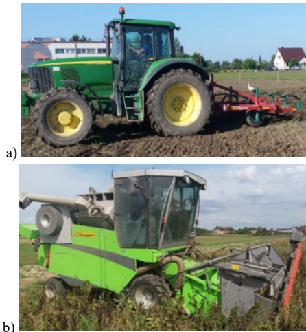
1 pav. Eksperimente naudoti: a) armens purentuvus Kverneland CLG-II; b) derliaus nuėmimo kombainas Wintersteiger Delta (nuotraukos R. Kimbirauskienės).
